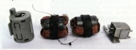
Obr. 6. Zleva: zaklapávací toroid, cívky 140 mH pro nf filtr, hlava z kazetového magnetofonu
