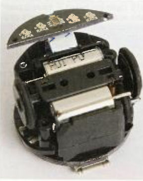
Obr. 8 a 9. Deska s elektronikou, zespodu pak pohon a deska s čidly
