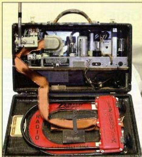
Obr. 3. Pohled dovnitř přijímače Trans-Oceanic TG605 a na jeho antény Shortwave Magnet a Wave Magnet, umístěné v zadním víku
